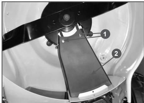
Рис. 25 Кожух защитный ремня привода 1. Винт 2. Кожух
