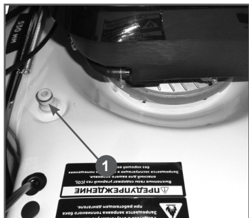
Рис. 24 Расположение коннектора для подключения шланга А - коннектор
